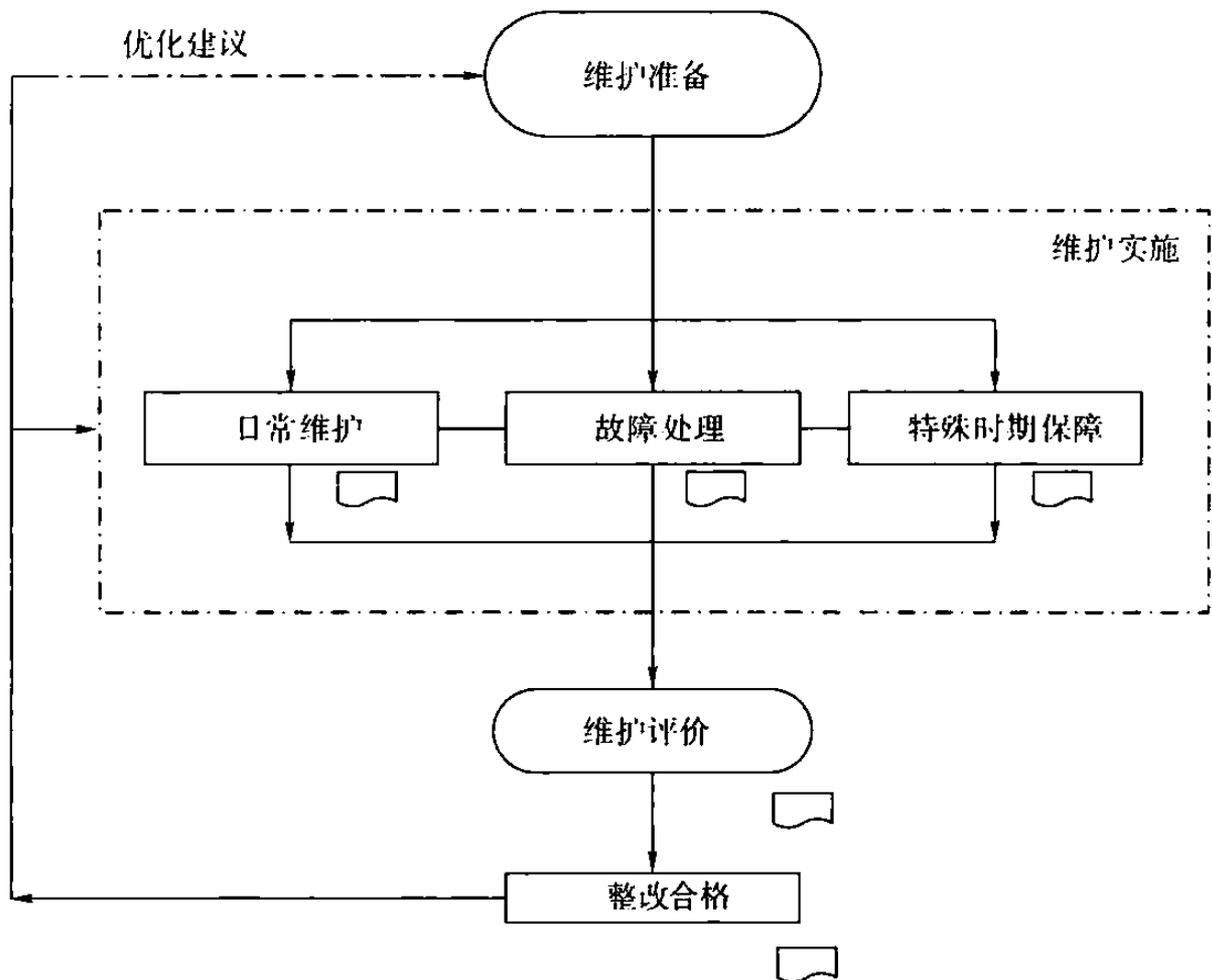
图 10 安全防范系统维护工作程序
