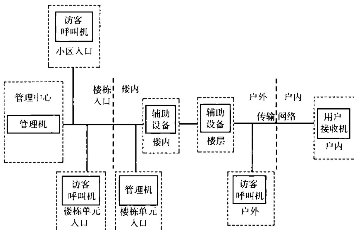
图 6 楼寓对讲系统应用构成示意图
