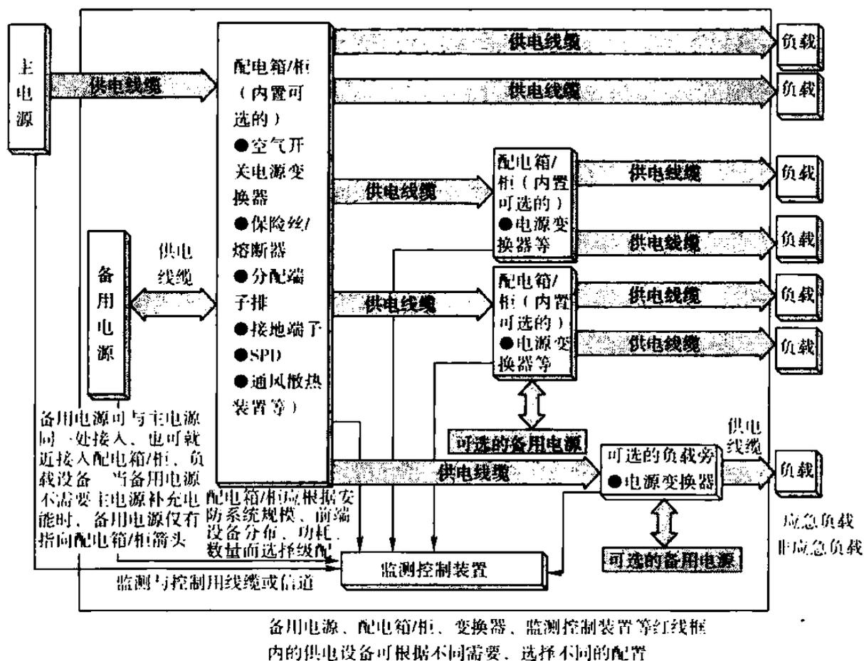
图7 安全防范系统供电系统构成示意图
