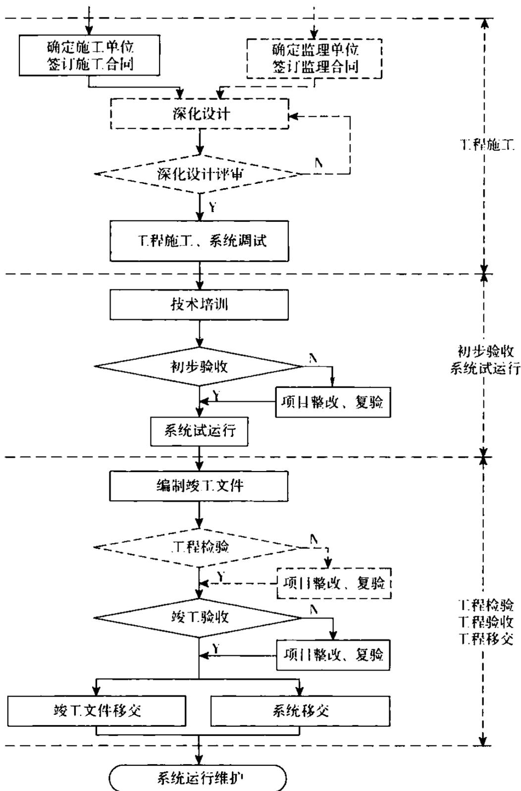
图2 安全防范工程建设程序示意图(续)
