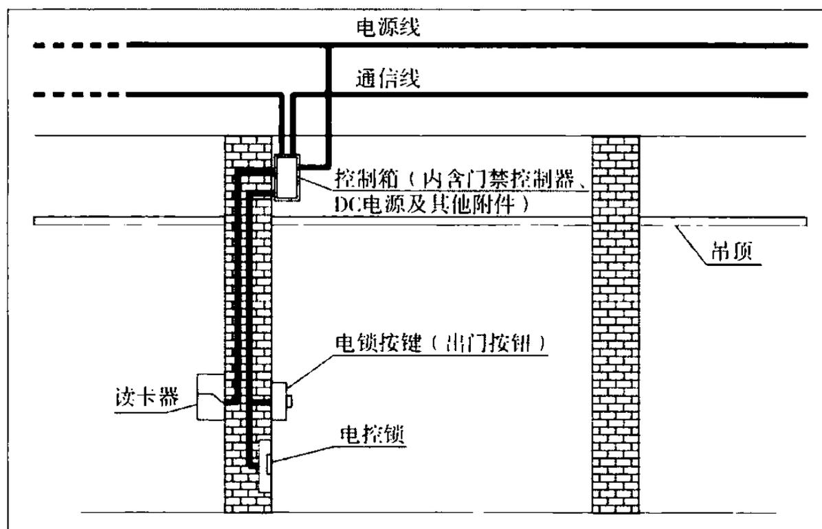
图8 出入口控制设备安装管线示意图
