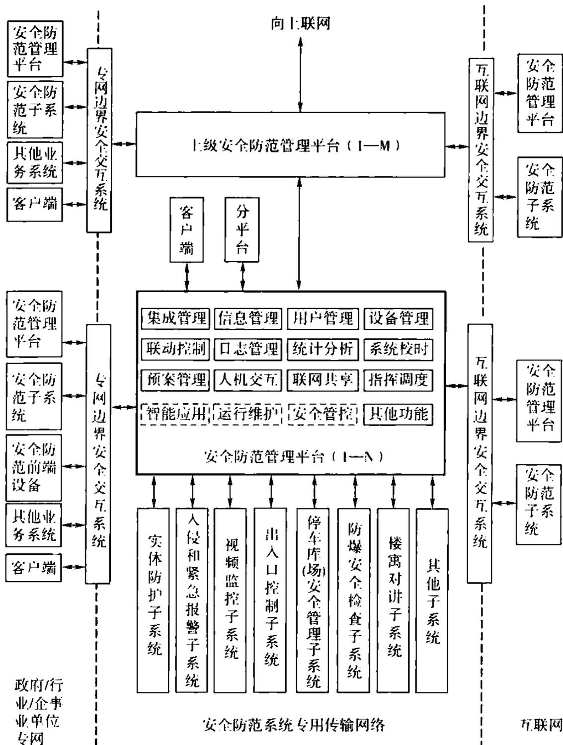
图 1 安全防范系统集成联网架构图
