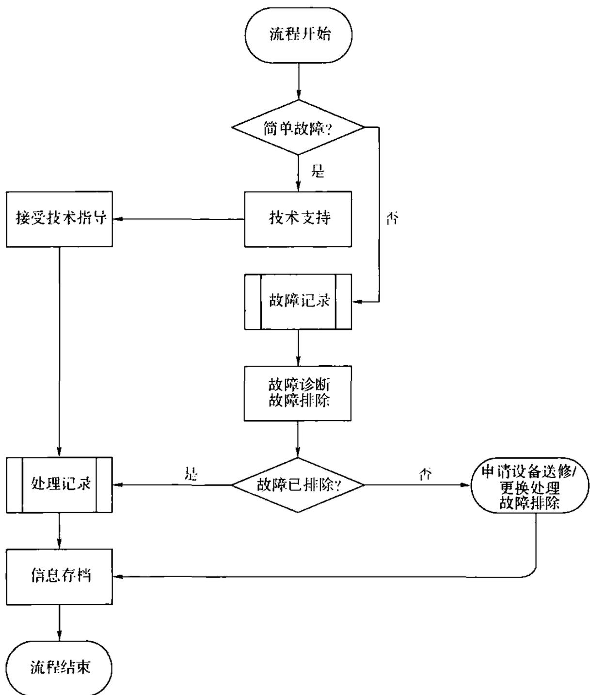
图 12 安全防范系统故障处理工作程序
